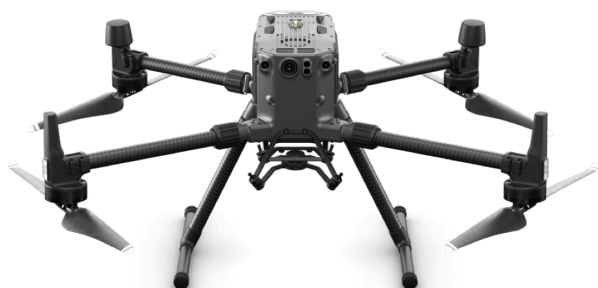
ドローン機：DJI製 Matrice300-RTK (DJI社HPより画像転載)
