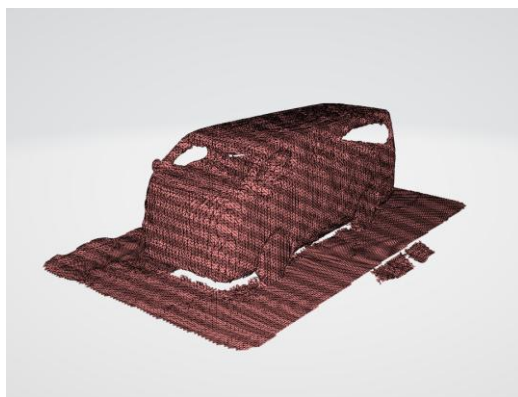
撮影画像より三次元化された 対象物 (テスト対象の車両のガラス部分 はモデル化されない)
