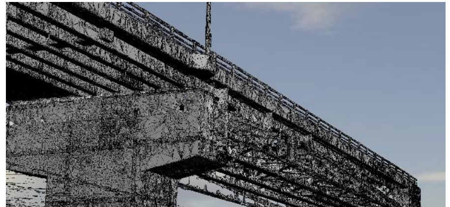
防護柵形状が三次元データ化されている様子(ワイヤフレーム表示)
