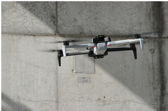
壁面にある、ひび割れの入ったテストピースの近接撮影の様子 (壁面との最接近距離40cm)
