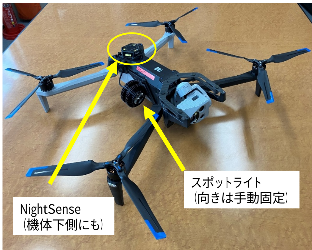
2種類の外付け照明を装着した状態
