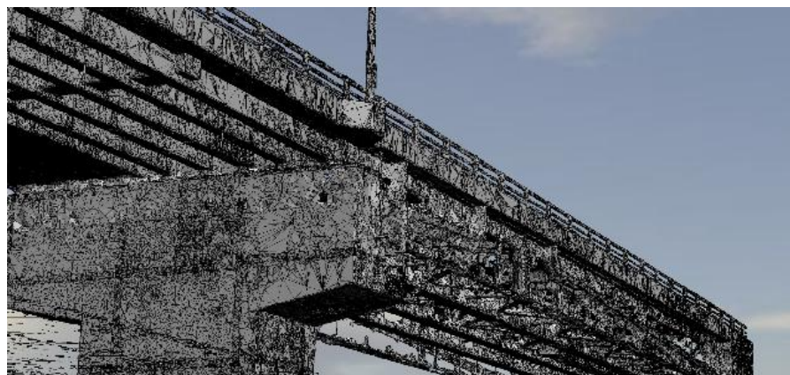
防護柵形状が三次元データ化されている様子(ワイヤフレーム表示)
